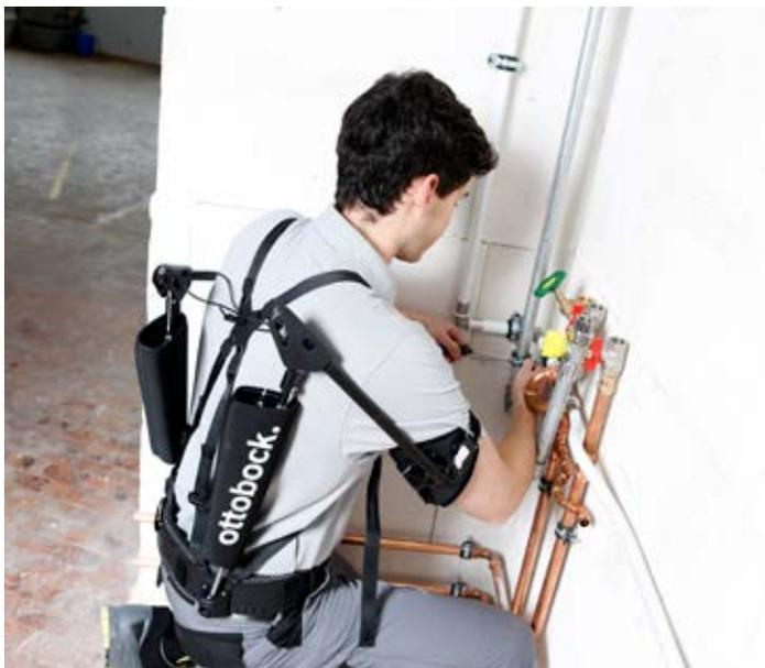
L'exosquelette Paexo Shoulder aide les employés des secteurs de la production et de la construction au cours d'activités pénibles, notamment les tâches effectuées au-dessus de la tête. Les bras levés sont soutenus par une technologie d'extension novatrice qui soulage significativement les muscles ainsi que les articulations dans la région de l'épaule. Ainsi, les tâches au-dessus de la tête sont bien plus faciles à effectuer.
